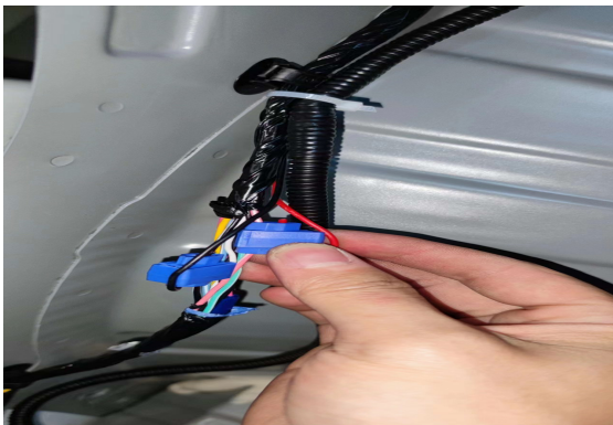
3. 剥开倒车灯线束保护胶带，倒车灯线束粉白色线与雷达线束红线使用接线夹连接，倒车灯线束黑线与雷达线束黑线用接线夹连接。
