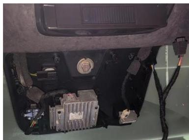
2.拔下接头，并手握原车后视镜支架逆时针旋转卸下后视镜。
