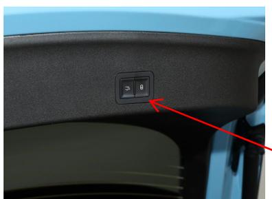
2.用翘板将后备箱装饰盖撬开缝隙，扣下装饰盖放置一边。
