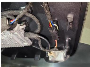
1.产品主机电源线与原车电源接头对插(注 须先拆下原车后视镜装饰盖, 即步骤 5.2.1) ;
