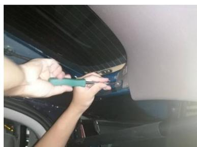
1.用十字螺丝刀拆下装饰盖两侧固定螺丝，并整理保管。
