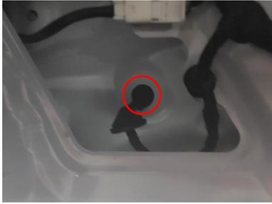
3. 摄像头线束由外饰板左侧线束孔穿出，与延长线对插连接并用扎带固定与合适位置。
