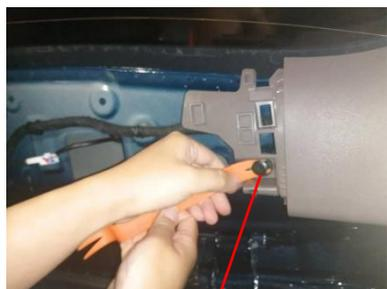
1.用翘板撬出侧面装饰盖固定螺钉，然后扣下侧面装饰盖板。
