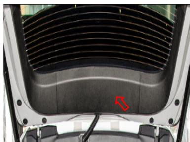
1.用翘板在装饰盖板侧面翘起缝隙，沿缝隙扣下装饰盖板，妥善放置。
