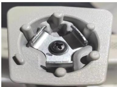
1.用十字螺丝刀拆下原车固定螺丝与底座，将其固定至流媒体后视镜的安装支架上;将流媒体后视镜的安装支架组装完全。
