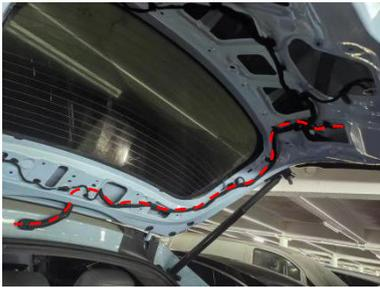
1.摄像头线束穿过后备箱车架与延长线连接，并用扎带固定于合适位置；延长线参考图片走线。
