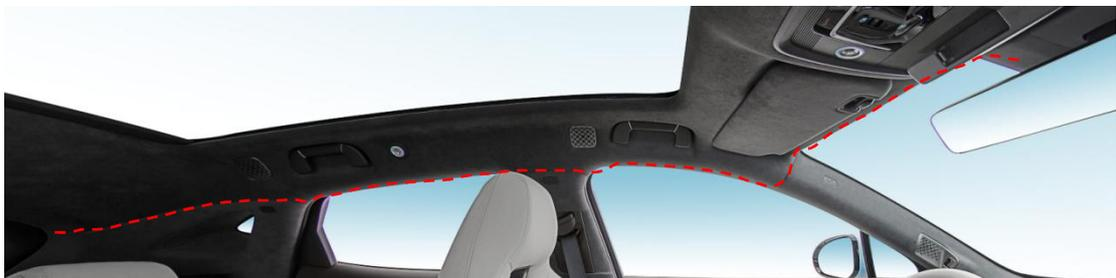
3.车内走线，线束由左后窗的位置穿出，沿着侧面车窗密封条和顶部装饰板与侧面装饰板的拼接缝隙，走线至前挡风玻璃左边框处。
