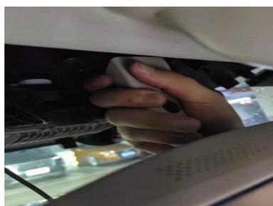
2.手握流媒体后视镜安装支架，对准安装孔位顺时针旋转，安装好流媒体后视镜。
