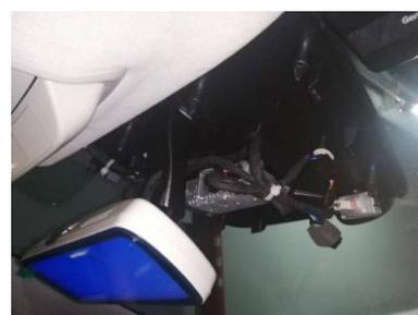
3.流媒体后视镜电源线与原车电源线连接，用扎带固定于右侧；摄像头信号线与延长线连接，用扎带固定于左侧。
