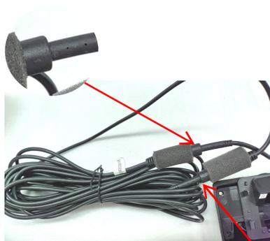
2.主机摄像头线与视频延长线一端对插, 后视摄像头线与视频延长线标签端对插 ;
