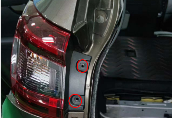
1. 拆卸后尾灯螺丝，断开尾灯插座，取下尾灯（左右相同）
