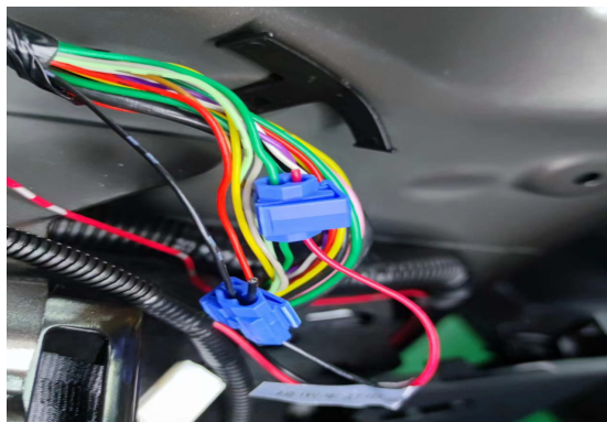
3. 剥开倒车灯线束保护胶带，倒车灯线束浅绿色线与雷达线束红线使用接线夹连接，倒车灯线束黑线与雷达线束黑线用接线夹连接。
