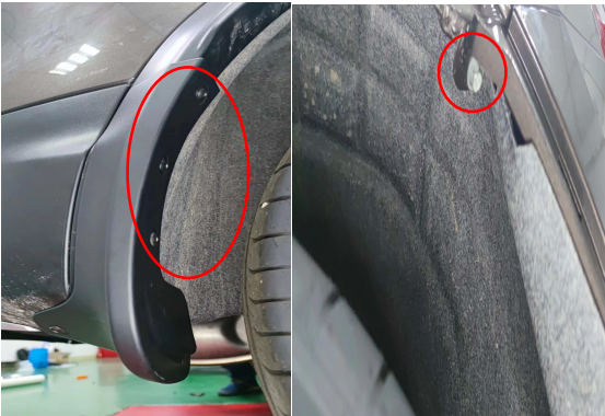
3. 拆卸后保与后叶子板连接处固定的螺丝和后轮挡泥板部位的螺丝（左右相同）
