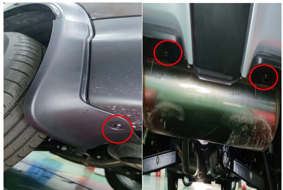
4. 拆卸后保险杠底盘下的固定螺丝和卡扣
