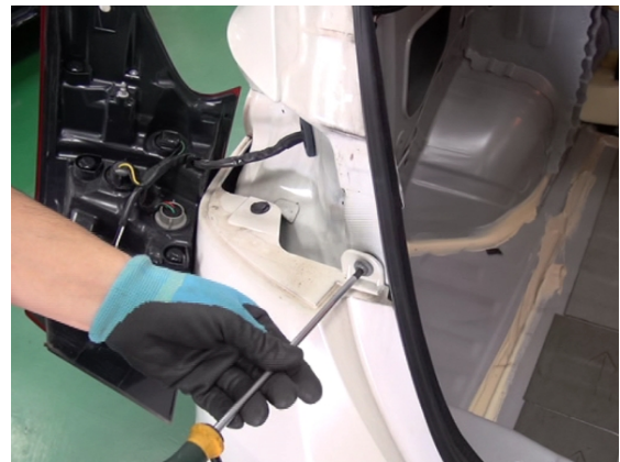
4. 拆卸尾灯处的后保险杠螺丝（左右相同）
