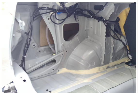
2. 找到后尾箱倒车灯线插座，后背箱内线束使用尼龙咋带和车辆主线束固定。
