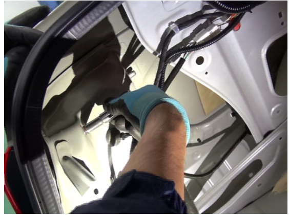
2. 拆卸后保险杠螺丝、拆卸后尾箱踏板。
