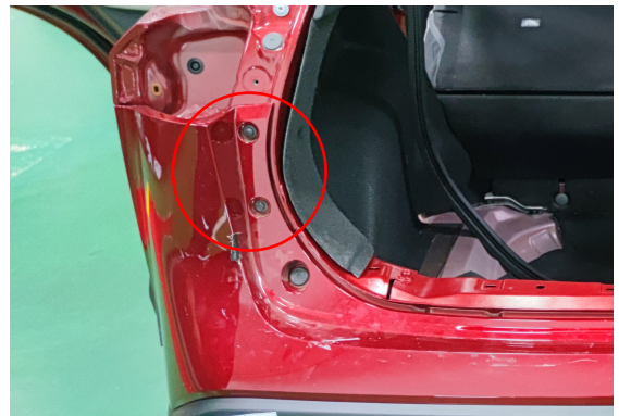
2. 拆卸后保险杠上边沿的螺丝和卡扣（左右相同）
