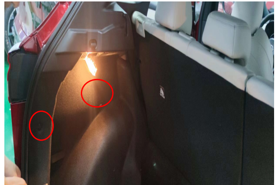
2. 拆卸后备箱内装饰板卡扣，拆卸内饰板
