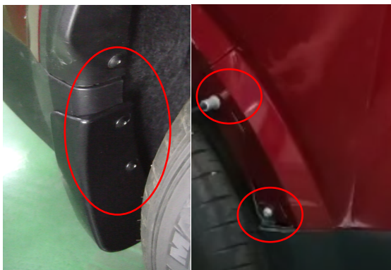
3. 拆卸后保与后叶子板连接处固定的螺丝和后轮挡泥板部位的螺丝（左右相同）
