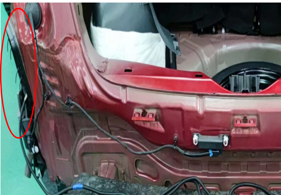
1. 从左侧排气窗穿入线束连入后尾箱内
