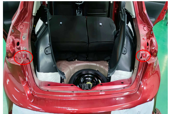
2. 拆卸后保险杠上边沿的螺丝（左右相同）
