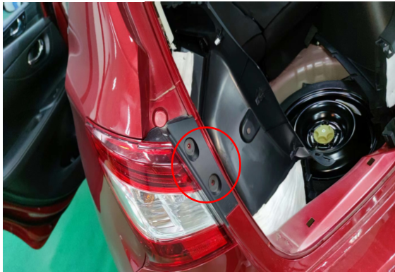
1. 拆卸后尾灯螺丝，断开尾灯插座，取下尾灯（左右相同）
