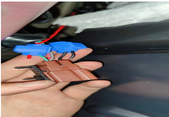
3. 剥开倒车灯线束保护胶带，倒车灯线束绿色线与雷达线束红线使用接线夹连接，倒车灯线束黑线与雷达线束黑线用接线夹连接。
