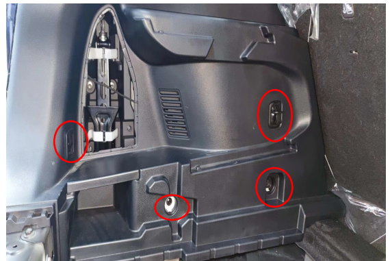
2. 拆卸后备箱左内装饰板卡扣螺丝，拆卸内饰板
