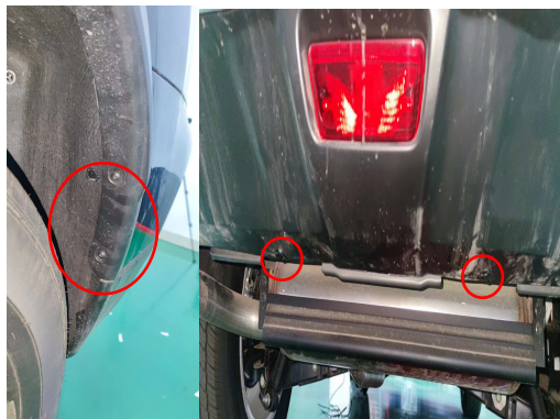
3. 拆卸后保险杠底盘下的固定螺丝和卡扣
