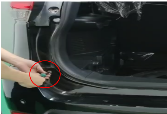
1. 拆卸后保险杠上边沿的螺丝（左右相同）
